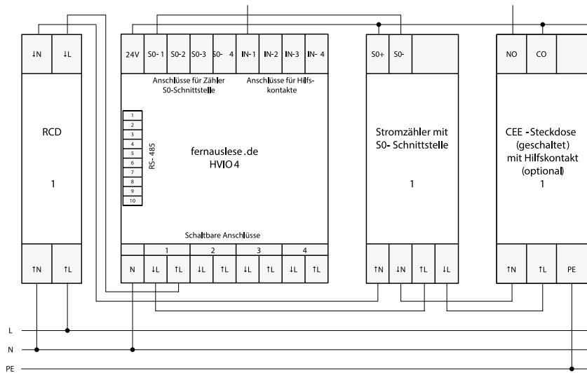
**Beispiel 2:** Eine fernschaltbare Steckdose und dazugehöriger Stromzähler mit Fernauslese sowie eine nicht fernschaltbare Steckdose und dazugehöriger Stromzähler mit Fernauslese
